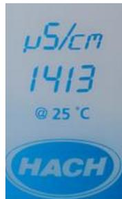
On fixe la conductivité à une certaine valeur à l'aide d'une solution ETALON de conductivité  $\sigma$  connue précisément à une température donnée ( Ex : Solution de chlorure de potassium,  $K^+$ ,  $Cl^-$  de  $\sigma = 1413 \mu S$ )
